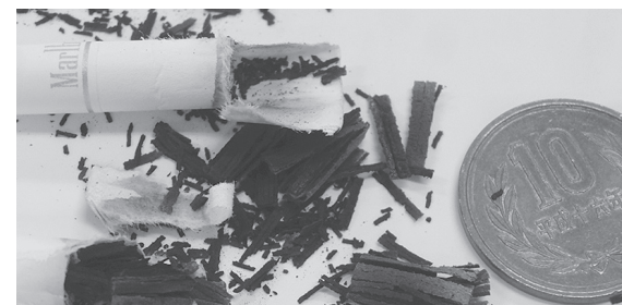
上・写真3 加熱により黒焦げになったヒートスティック。
